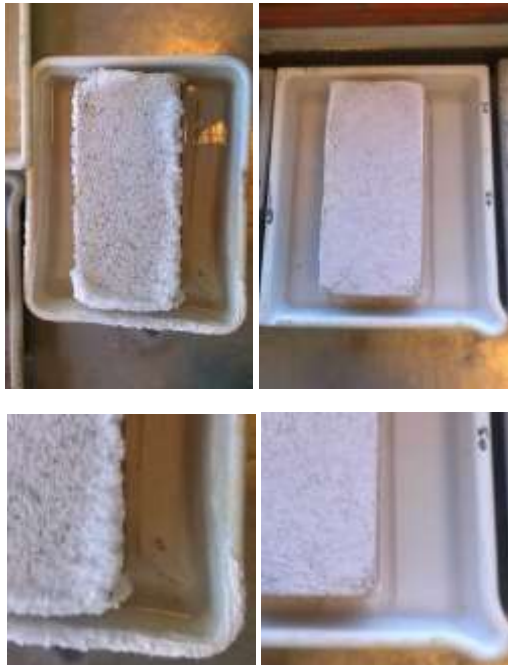
Αφυγραντικός σοβάς ύστερα από την δοκιμή σύμφ. RILEM MS-A 2
